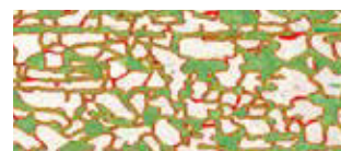
Количественная оценка микроструктурной полосчатости
