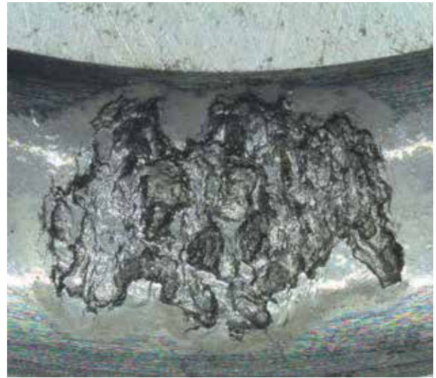
Дефект в упорном подшипнике, светлое поле, увеличение – 50х
