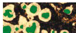
Определение содержания перлита и феррита в чугуне по ГОСТ 3443
