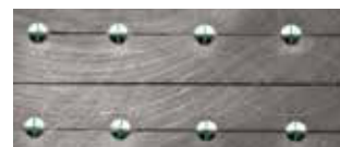
Анализ твердости по Бринеллю, ГОСТ 9012
