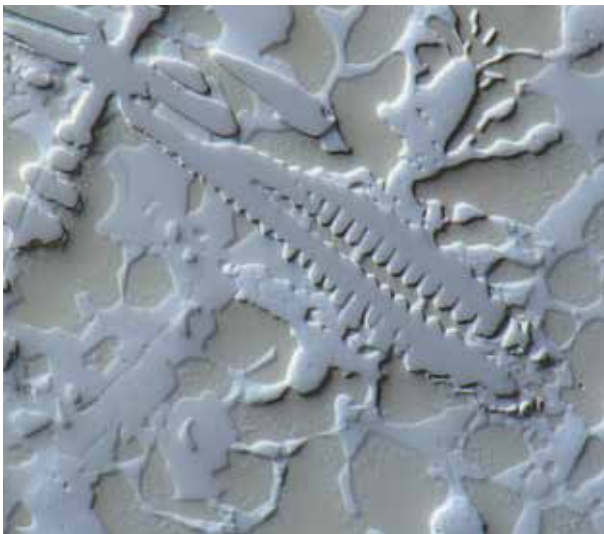
Литой твердый сплав на основе WC, ДИК-контраст, увеличение – 3000x
