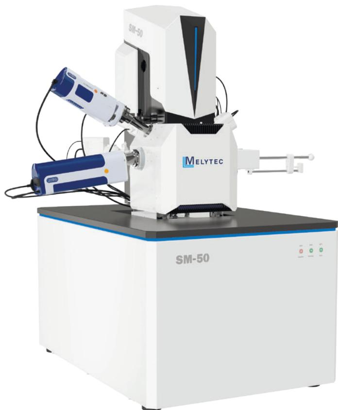
СЭМ SM-50 имеет высокое разрешение (до 0,8 нм), которое сочетается с высоким контрастом изображения благодаря автоэмиссионному катоду типа Шоттки и использованию передовых сверхчувствительных детекторов.
