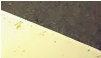
Хорошая адгезия с краями образца
